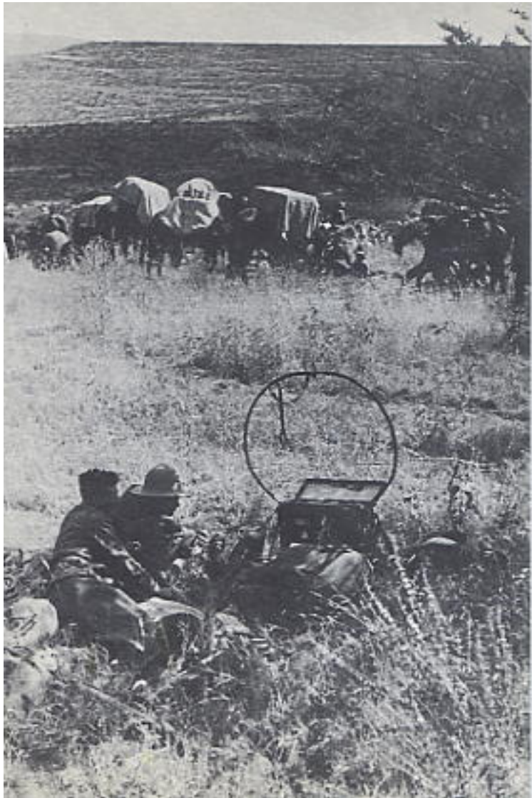
1936/37 zona di operazioni in Africa Orientale Guerra Italo-Etiopica, collegamento delle truppe in marcia con gli aerei da ricognizione in volo, effettuato con radio portatili R3.
